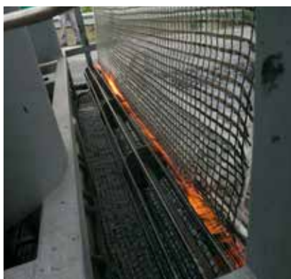
Calentamiento del revestimiento de betún
